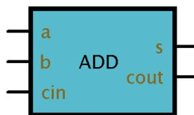
Figure II-1. Un additionneur est un circuit combinatoire
